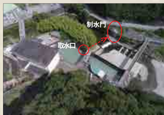
大井川用水の総取入口「川口取水工」 (事業概要図 施設番号①)
